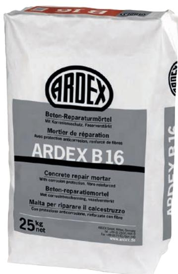
Der neue faserverstärkte PCC-Betonersatzmörtel ist geeignet für Beton, Sichtbeton, Betonfertigteile und Zementputz. Durch seine sehr guten Verarbeitungseigenschaften lässt er sich in Schichtstärken von 5 bis 70 mm pro Arbeitsgang auftragen. Ein weiteres Merkmal ist die hohe Belastbarkeit. Aufgrund seiner hohen Festigkeit ist ARDEX B 16 als Betonersatzmörtel der Klasse R4 nach DIN EN 1504-3:2006 geprüft und somit für die statisch relevante Instandsetzung geeignet.
