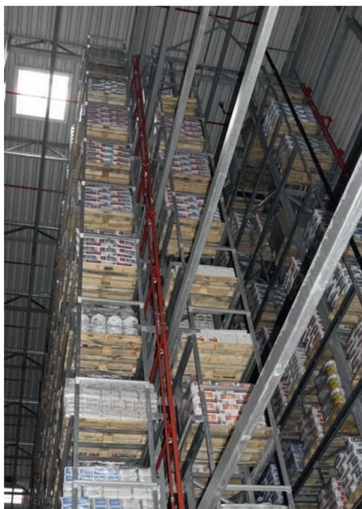
Das neue Hochregallager verfügt über insgesamt 13.293 Palettenstellplätze. Die Osterfeiertage hatte Ardex im Vorfeld für eine finale Testphase der vollautomatischen Förder- und Lagertechnik genutzt.
