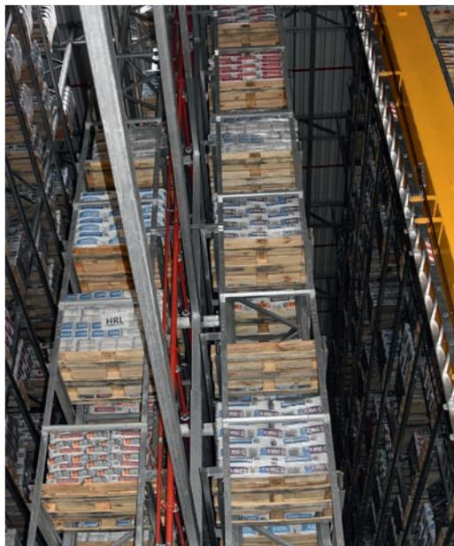
Auf bis zu 26,5 Metern Höhe werden die Paletten eingelagert. Sechs Regalbediengeräte verteilen sich dabei auf die 30 Meter breite und 100 Meter lange Halle.
