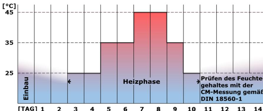
Am 3. Tag nach Einbau des Heizstrichs, hergestellt mit den ARDEX-Bindemitteln A 58 / A 60 / A 38 / A 35 oder den WTM A 38 MIX / A 35 MIX, kann mit dem Aufheizen begonnen werden.
