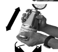
7) Durch kräftiges Hin- und Herbewegen sowie durch kreisende Bewegungen das Prüfgut im CM-Gerät mit Hilfe der Kugeln völlig zerkleinern.
