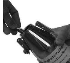
5) CM-Gerät schräg halten und Glasampulle mit Calciumcarbid vorsichtig einfüllen.
