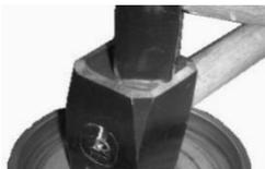
2) Durchschnittsprobe im Beutel in der Schale so weit zerkleinern, dass ein völliges Zerkleinern in dem CM-Gerät mit den Kugeln möglich ist.
