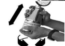
7) Durch kräftiges Hin- und Herbewegen sowie durch kreisende Bewegungen das Prüfgut im CM-Gerät mit Hilfe der Kugeln völlig zerkleinern.
