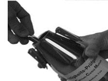
5) CM-Gerät schräg halten und Glasampulle mit Calciumcarbid vorsichtig einfüllen.
