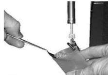
3) Prüfgut mit Löffel und Waage abwägen:
