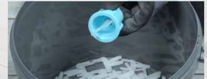
Durch Druck auf die Schnellarretierung fällt der Gewindestaschenrest heraus
