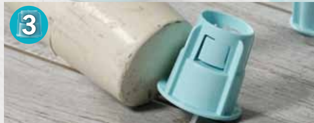
3 Leichtes Abschlagen der Drehknöpfe nach Aushärtung des Klebers
