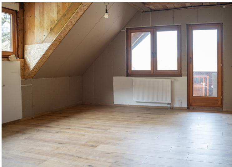
Die Bauarbeiten verliefen problemlos und wie geplant, der Einbau des Bodens konnte termingerecht ausgeführt werden. Für die Fliesen in Holzoptik wurde der Untergrund mit der Haft- und Gründierdispersion ARDEX P 51 grundiert. Die Fliesen selbst wurden mit dem MICROTEC3 Flexkleber X 90 verlegt. Drei Verarbeiter auf der Baustelle reichten aus, um den Boden auf der die 85 Quadratmeter große Fläche in dreieinhalb Tagen mit relativ wenig Personalaufwand einzubauen.
